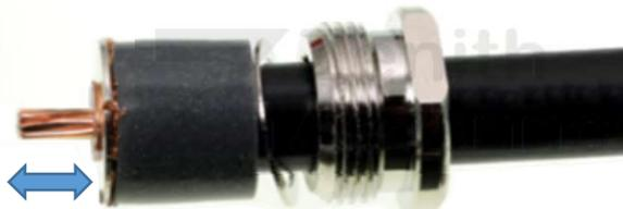
*(\* Utiliser un outil de coupe à mors arrondis pour préserver la forme cylindrique du conducteur (Une pince coupante classique "aplatit" l'âme centrale et rend difficile son insertion dans la pin centrale du connecteur)*
