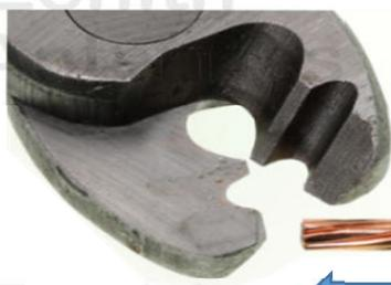
(\* Utiliser un outil de coupe à mors arrondis pour préserver la forme cylindrique du conducteur (Une pince coupante classique "aplatit" l'âme centrale et rend difficile son insertion dans la pin centrale du connecteur)
