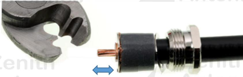
(\* Utiliser un outil de coupe à mors **arrondis** pour préserver la forme cylindrique du conducteur (Une pince coupante classique "aplatit" l'âme centrale et rend difficile son insertion dans la pin centrale du connecteur)
