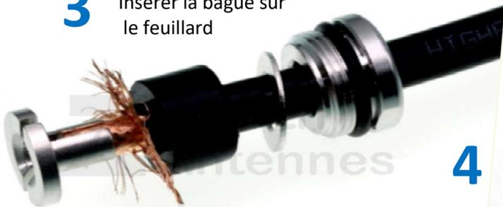
La bague doit être insérée **entre** le feuillard et le blindage extérieur
