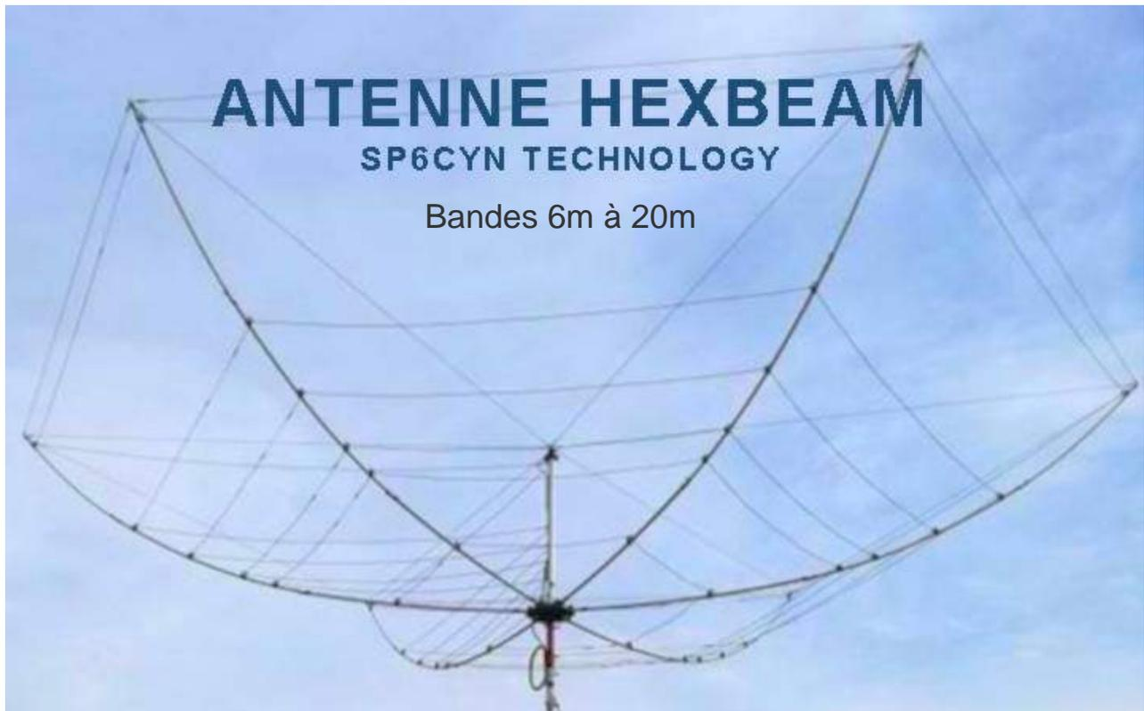
L'antenne HEXBEAM est une antenne directionnelle "plug-and-play", elle ne nécessite pas de réglage supplémentaire.
