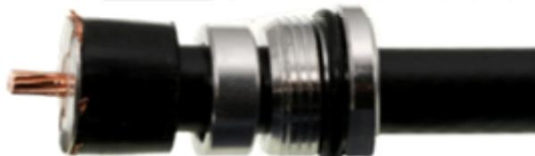
**9** Enfiler le premier isolant PTFE, et enfiler la pin centrale sur l'âme du câble (Cet isolant peut ne pas être présent, selon le modèle de connecteur)
