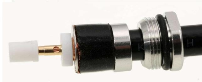
**12** Glisser l'ensemble dans le corps du connecteur et serrer avec 2 clés
