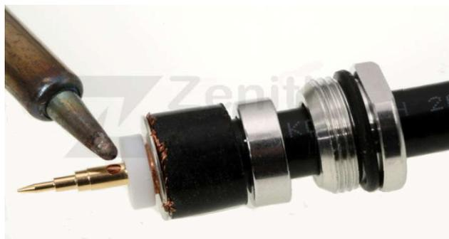
**11** Enfiler le deuxième isolant sur la pin centrale
