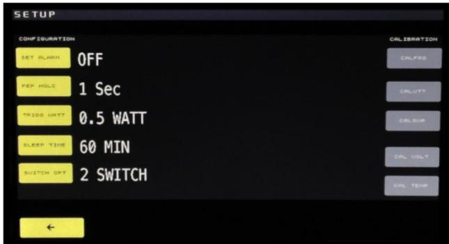
**MENU SETUP :** A travers ce menu, il est possible de définir une alerte du SWR. Le temps de rémanence de la puissance PeP en seconde. La puissance minimale pour effectuer des mesures. Le délai pour le basculement en veille. Le nombre de commutateurs connectés. Et tous les étalonnages de la fréquence, puissance, SWR ; pour chaque bande. La tension et la température également.
