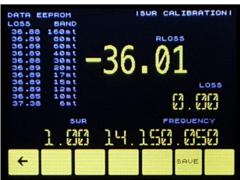
**CALSWR** : Au travers de ce menu, il est possible de recalibrer la partie SWR. Connecter la radio et régler une puissance de transmission à 10W en ne connectant aucune antenne. Attention, cette opération pourrait endommager les émetteurs fragiles. Passez succinctement en émission et pressez simultanément le bouton SAVE. Répétez cette opération sur les 11 bandes.
