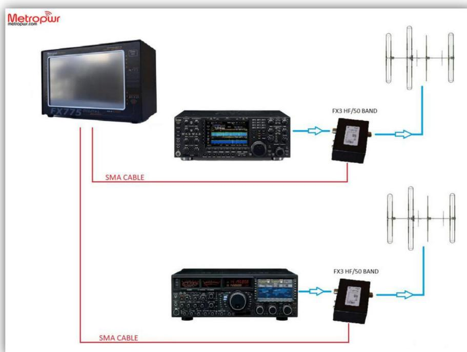
**FX3/5 connexion :** la connexion basique pour la bande HF/50MHz (utilisation des cables SMA).
