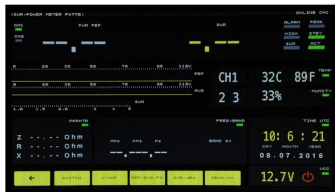
**MENU WATTMETRE :** Permet de visualiser la puissance PeP (crête), AVG (moyenne), tous les paramètres SWR, R, Z, X, la fréquence utilisée, la bande, la température et l'humidité interne, la date, et la possibilité de sélectionner la sonde et le commutateur d'antenne.
