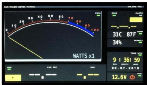
**MENU SMETER** : identique au menu précédent, mais avec un affichage analogique. Cet instrument virtuel ajuste automatiquement l'échelle via un facteur X. Exemple : si l'aiguille affiche 10 et un facteur X100, la puissance mesurée est alors de 1000W PeP.
