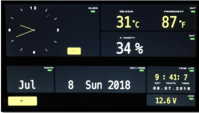
**MENU CLOCK :** L'appareil possède une puce dédiée pour l'horloge et un calendrier pré-renseigné perpétuel. Il est possible de modifier l'heure via le sous-menu SET. Il est également possible d'afficher la température et l'humidité en % de l'instrument et d'autres paramètres opérationnels. Le capteur est disposé sur la partie arrière dans l'axe des orifices de ventilation.
