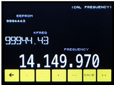
**CALFREQ** : Au travers de ce menu, il est possible de calibrer le fréquencesmètre interne. Pour ce faire transmettez un signal sur 10MHZ et réglez à l'aide des touches +/- +/- l'affichage correct de la fréquence à 10.000.000 Hz sur l'écran. Mémoriser en touchant SAVE.
