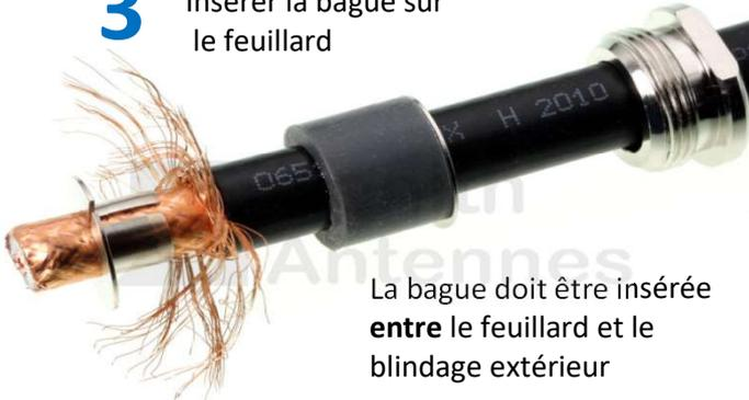
La bague doit être insérée **entre** le feuillard et le blindage extérieur
