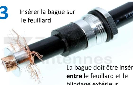
La bague doit être insérée **entre** le feuillard et le blindage extérieur
